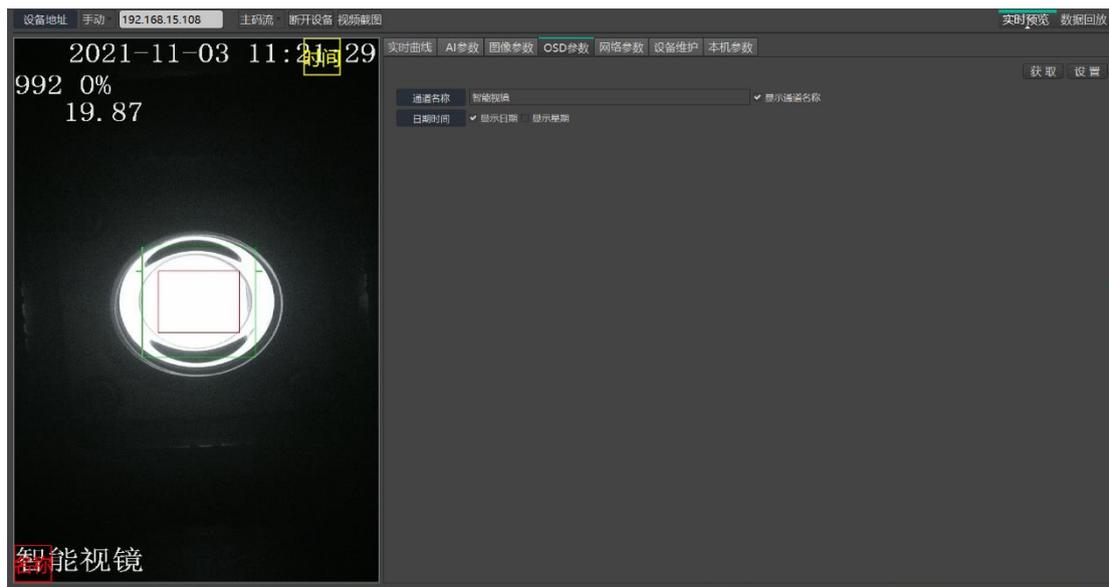
点击“获取”，获得智能视镜的 OSD 参数。可以对通道名称、时间日期显示进行设置。
